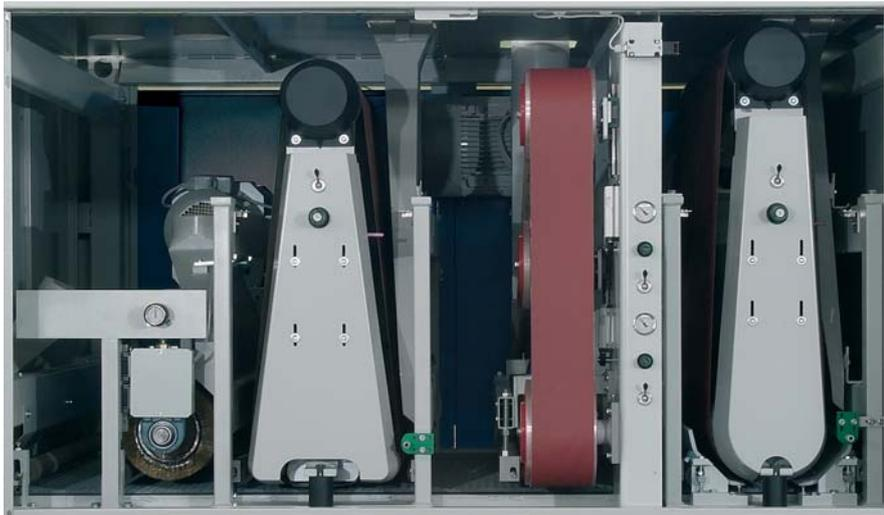
TAG 1T2 EU - Calibratrice levigatrice a tre nastri con rullo calibratore, nastro trasversale, nastro longitudinale e spazzola strutturatrice.
