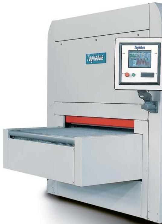
**EuroSander Modello TAG 13 KS con rullo di contatto e tampone SuperFinitore per la levigatura di vernice - larghezza di lavoro 1700 mm**
