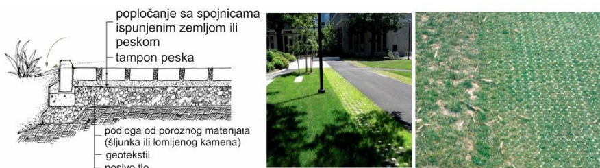
Slika 6. Porozni zastor; detalj poroznog zastora;
