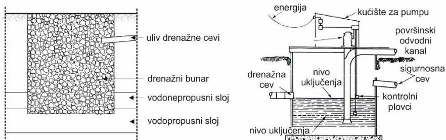
Slika 5. Izgled drenažnih bunara za potrebe prikupljanja veće količine atmosferskih voda
