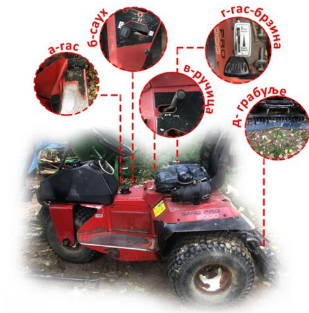
Sl. 3: Mašina za uređivanje peska u banker
