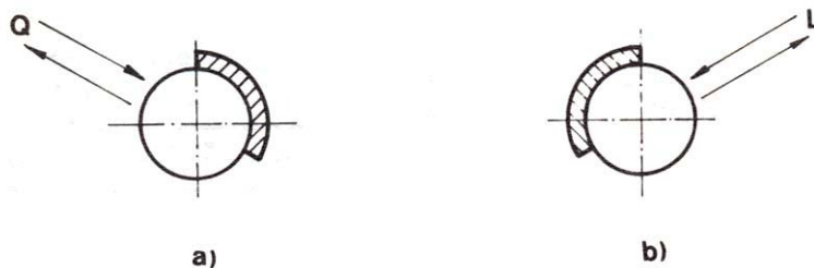
Slika 3: Poluizolovan sistem: a) mehanički izolovan b) termički izolovan
