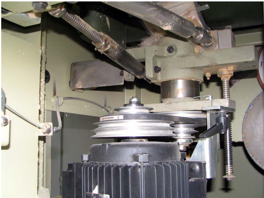
Slika P.10: Kardanska vratila kod kombinovane mašine (dole stepenasti kaišnik)
