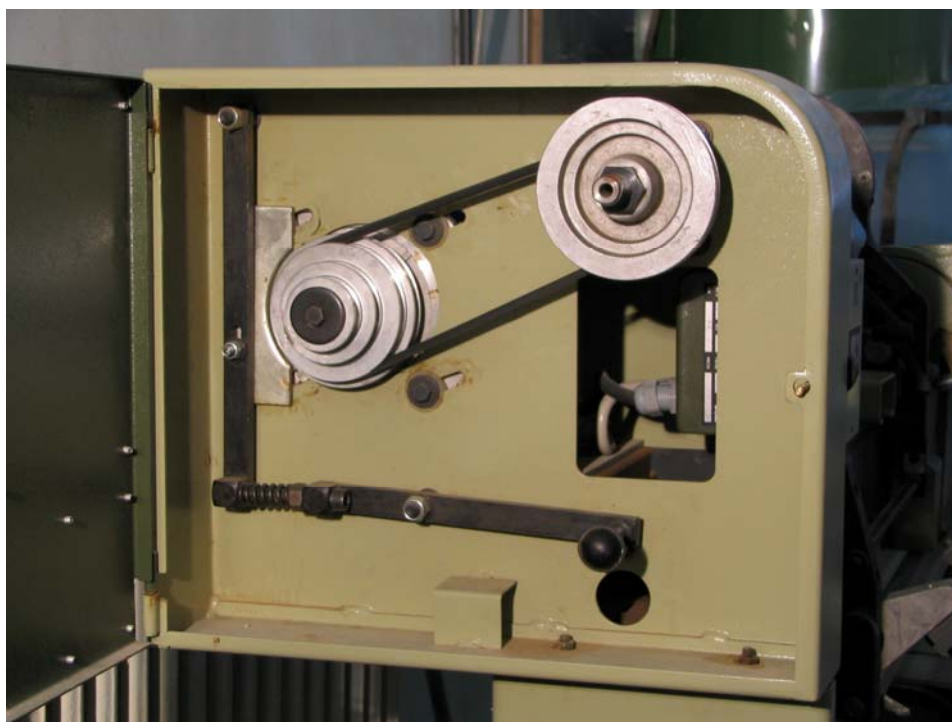
Slika P.2: Stepenasti kaišni prenosnik sa polužnim mehanizmom za stupnjevitu promenu broja obrta glavnog kretanja kod struga za tokarenje
