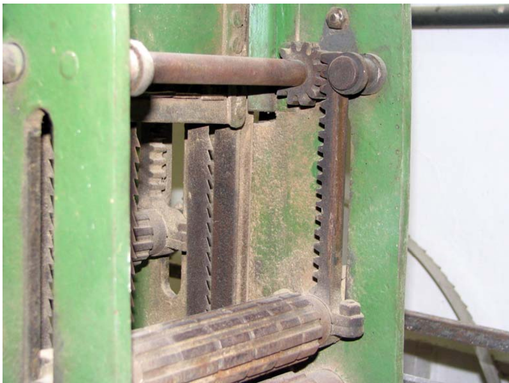
Slika P.14: Mehanizam zupčanik-zupčasta letva za primicanje i odmicanje valjaka za pomoćno kretanje, a prema prečniku trupca
