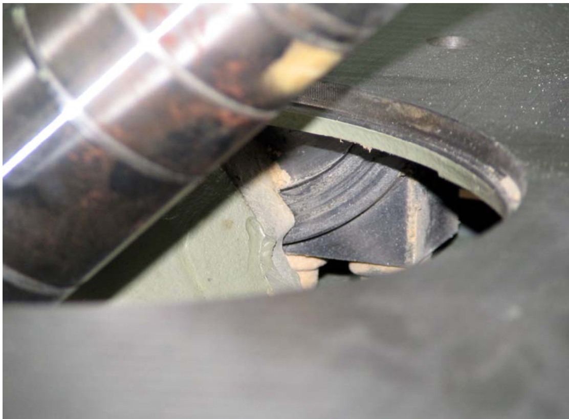
Slika P.11: Segmentna vodjica za zaokretanje stola kod vertikalnog vretena za glodalo kod kombinovane mašine
