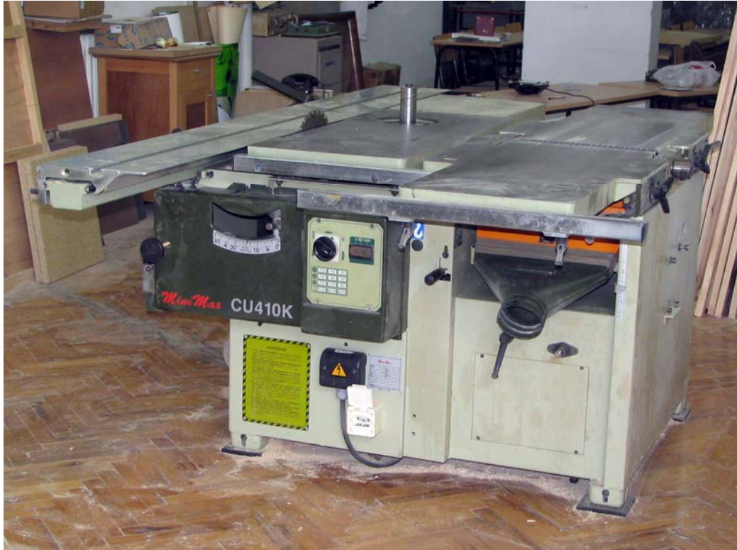
Slika P.7: Kombinovana mašina koja se služi za: ravnanje, glodanje i piljenje (Laboratorija za mašine i alate, Šumarskog fakulteta u Beogradu)
