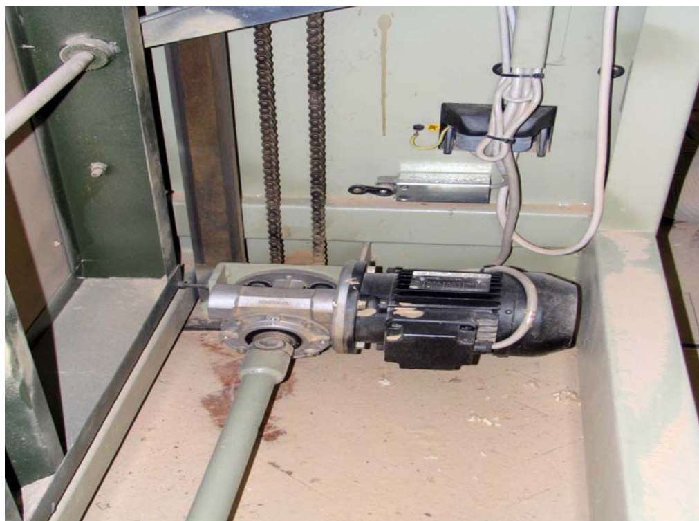
Slika P.4: Lanac sa pogonom elektro-motora za podizanje stola kod tračne brusilice
