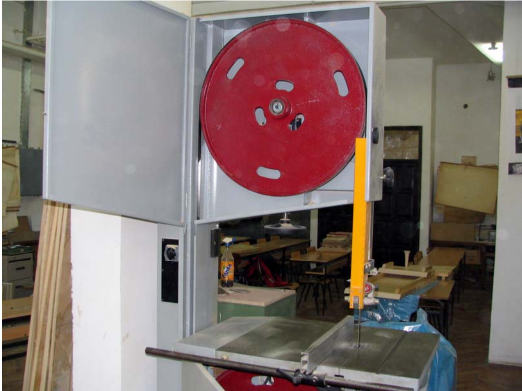
Slika P.5: Tračna pila sa gornjim vodjenim diskom (Laboratorija za mašine i alate, Šumarskog fakulteta u Beogradu)
